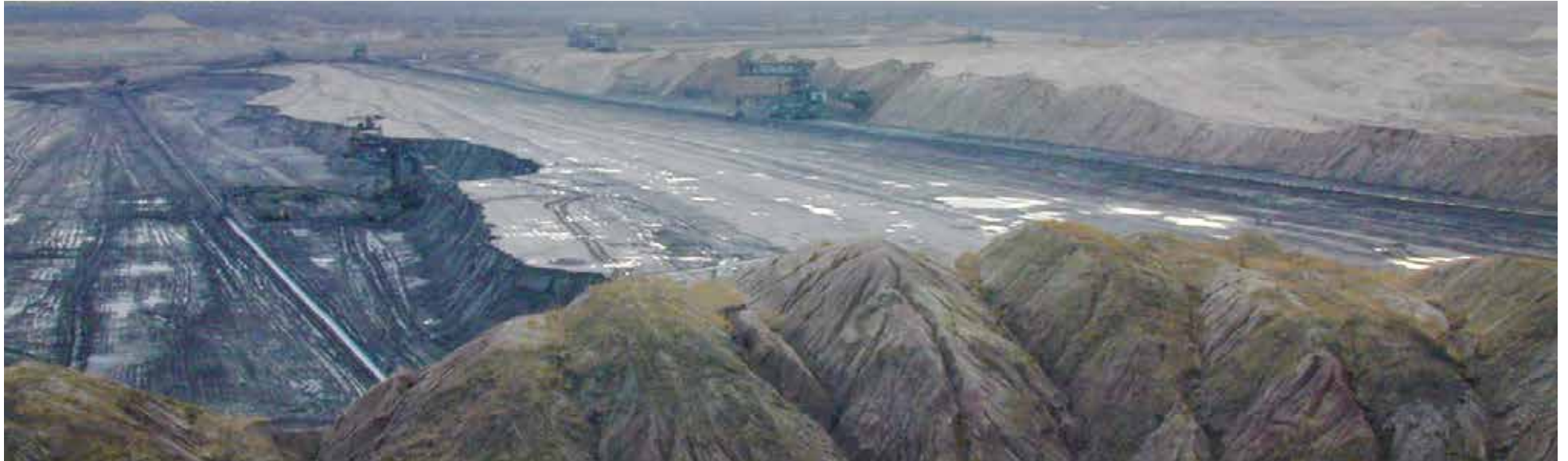
Rückgewinnung von wasserungesättigtem Abraum aus der Förderbrückenkippe zur Tagebausanierung, 2000
