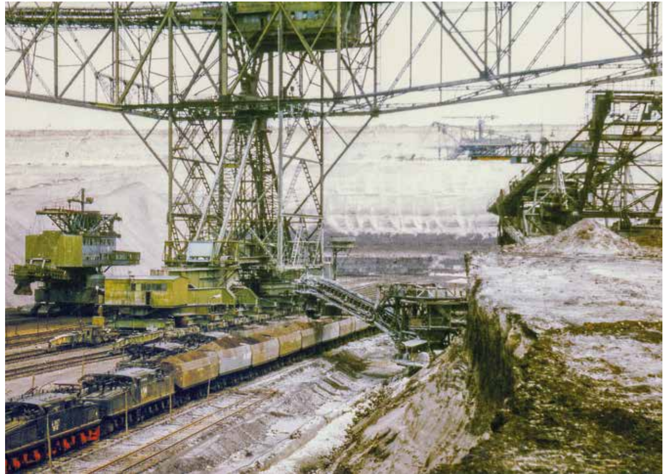
1989 wurde im Mittelschnitt die gebrochene Zug-/Bandförderung zur Leistungsstabilisierung eingeführt.
