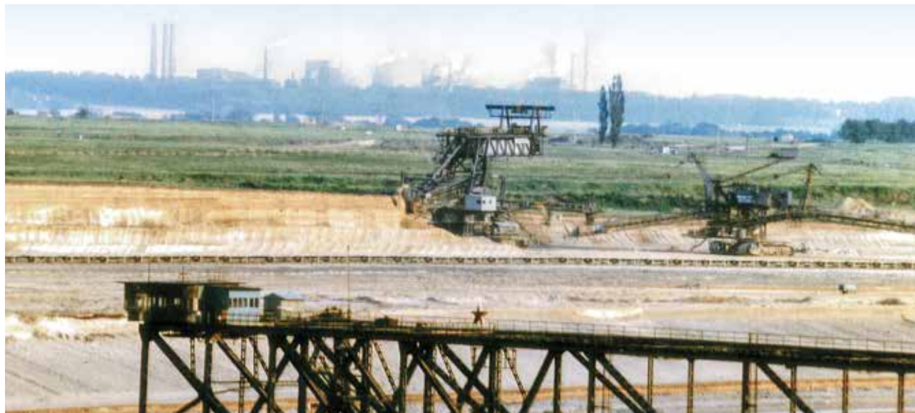
Zum Erhalt der Leistungsfähigkeit wurde der Vorschnitt des Tagebaues 1985 auf Bandförderung umgestellt.
