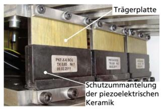
Abbildung 12. Eingebaute piezoerregte, aktive Federelemente (PKF-Elemente)
