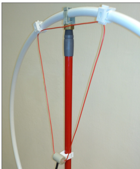
Bild 3: Befestigung der Koppelschleife an Hauptschleife und Tragemast (Besenstiel)
