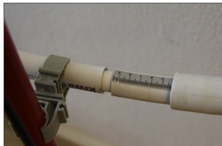
Bild 7: Die zweite Möglichkeit zum Feinabgleich besteht darin, ein dickeres Rohrstück (rechts) nahe der Lücke zu positionieren.
