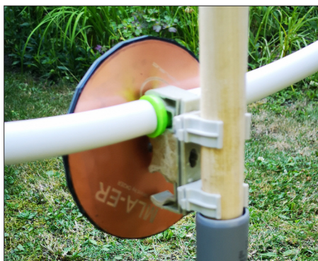
Bild 4: Abgleichplatte, die an einer Schelle über der nach dem Einschleiben der kurzen Rohre verbleibenden Lücke sitzt
