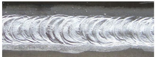
Bild 33: SpeedUp mit 1.2mm AlMg5, t=3mm, 100%Ar, 106A, 15V, 1.7kW, vD=6m/min, vS=31cm/min, 3.2kJ/cm
