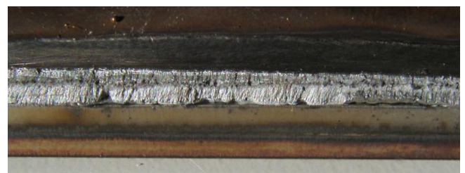
Bild 25: 1.4301, t=4mm, 1mm ER308, konventionell gepulst 110A/22V fallend geschweißt.
