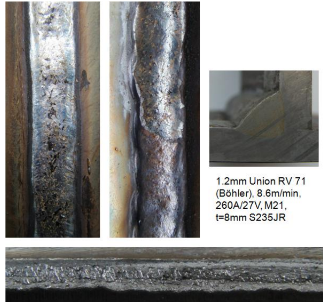
Bild 10: Impressionen vom Steignachtschweißen mit rutilen Fülldraht
