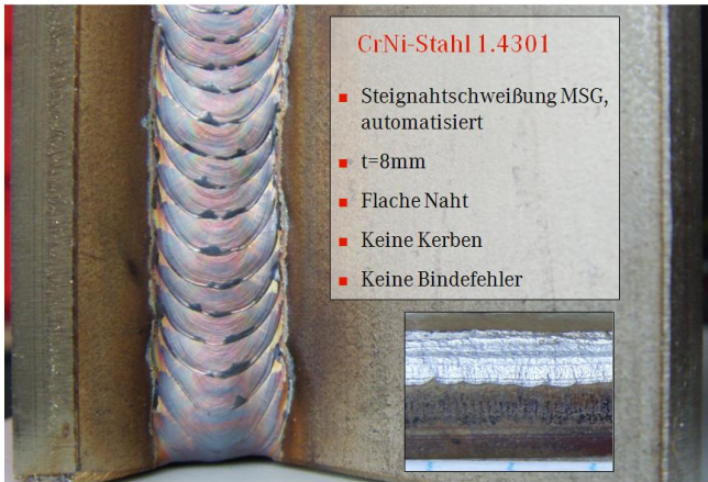
Bild 29: Bleche 1.4301 t=8mm, Draht 1mm 1.4316 (ER308) 98%Ar+2%CO 2 , SpeedUp automatisiert
