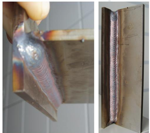
Bild 27: Automatisiert geschweißte Steignaht mit SpeedUp an 1.4301 t=4mm, Draht 1mm 1.4316 (ER308) 98%Ar+2%CO 2
