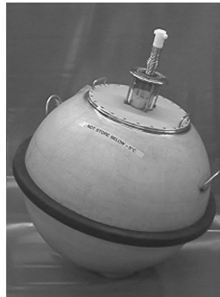
Abbildung 2-4: Seegangsmessboje WAVERIDER [DATAWELL BV, 2000]
