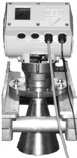
Abbildung 3-5: Ansicht des Radars VEGAPULS
