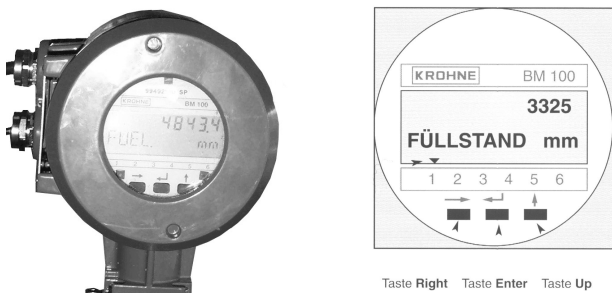
Abbildung 3-16: Steuerung der Radar-Sensoren BM100
