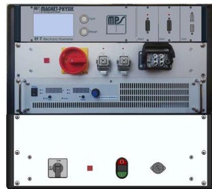
Geräteschrank der PERMAGRAPH® - REMAGRAPH® - Kombination C - 850 (mit optionaler Temperaturregelung TM 1 für Messungen von Permanentmagneten bei Temperaturen von bis zu 200 °C)
