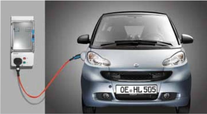
Beim konduktiven, d. h. leitungsgebundenen Laden, wird das Fahrzeug mittels Kabel und Steckvorrichtung mit der Netzinfrastruktur verbunden. Hierbei kann nach der Norm IEC 61 851-1 mit einer Ladeleistung von max. 43,5 kW (AC) und max. 240 kW (DC) geladen werden.
