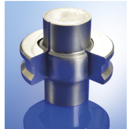
Abbildung 17: Durch Quer-Fließpressen hergestellte Wellen-Nabe-Verbindung (teilweise aufgeschnitten)
