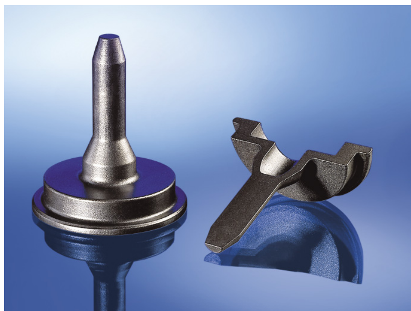
Abbildung 14: Durch Halbwarmumformung hergestellte Mittenwelle
