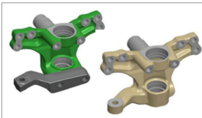
Die früher aus den zwei separat geschmiedeten Bauteilen Achsschenkel und Spurhebel bestehende Baugruppe wurde ersetzt durch ein monolithisches integriertes Schmiedeteil. Bild: CDP Bharat Forge
