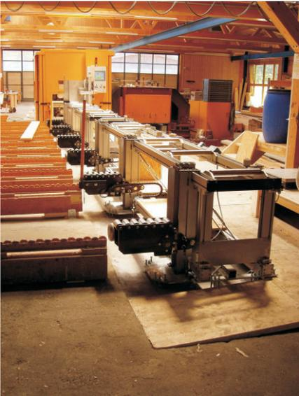
Rollenbahn mit Hubsäule im Profil. Hubsäulen auf MATMODUL-Basis mit einem Rollenbock können auch einzeln in weiterer Entfernung montiert werden. Grössere Konsolenausladungen und Lasten bis 800 kg pro Hubeinheit sind möglich durch Multiplikation der vertikalen MATMODUL-Stützen mit mehr Ausladung des Gegenhebels.
