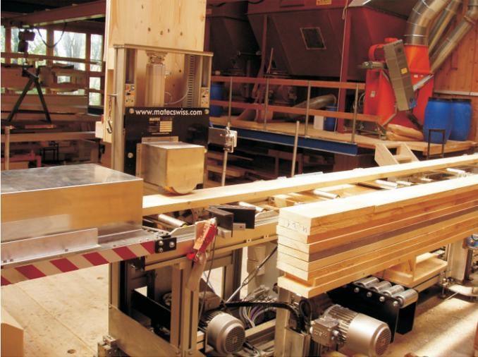
Auf- und absenkbare Einschubeinheit, Hubsäule
