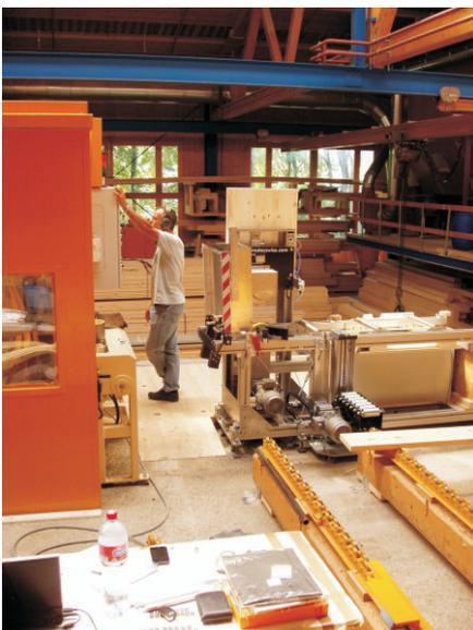
Links Schallschutzkabine Hobelmaschine, Bediener an Steuerung, offene Sicherheitsschranke, MATEC-Einschubeinheit mit Rolle oben (Ausgangsstellung), Rollenbahn mit Hubsäule 1. Wenn die Sicherheitsschranke geöffnet wird, stehen alle Vorschübe auf der Beschickungsseite still.
