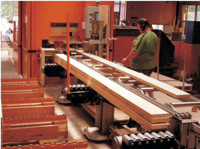
Bei dieser Anwendung werden entweder 2 Gruppen zu 3 Hubsäulen oder eine Gruppe zu 6 Hubsäulen geschaltet. Die Lamellen werden von Hand auf die Rollenbahn gezogen und der Einschub wird freigegeben und abgesenkt, sobald die Lamelle richtig am Anschlag liegt. Die Hubsäulen erkennen über einen optischen Sensor, wenn eine Lamelle vom Stapel entfernt wurde. Ueber eine programmierte Zeitverzögerung fährt das Lamellenpaket um eine Brettstärke nach oben.
