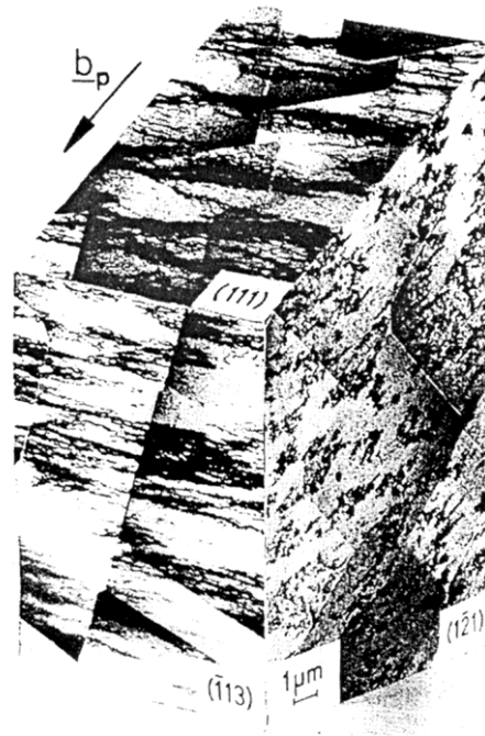
Abb.22: Dreidimensionale Darstellung der Versetzungsstruktur im Bereich A
