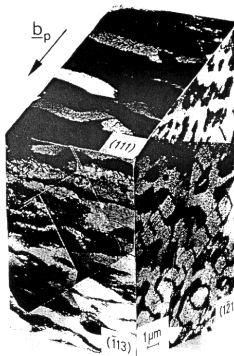
Abb.23: Dreidimensionale Darstellung der Versetzungsstruktur im Bereich B Matrixstruktur ist ähnlich der des Bereiches A.: Bündel/Ader-Struktur. In der Matrix eingebettet: Leiterstruktur bestehend aus Kanälen mit senkrechten Wänden. Diese
