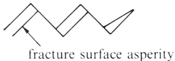
Abb.81: Schematische Darstellung von rauigkeitsinduziertem Rißschließen
