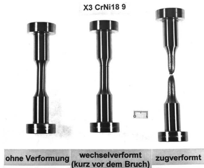
Abb.1: Bruch durch einsinnige und zyklische Beanspruchung
