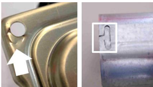
Abbildung-2: Durch hochkommende Stanzbutzen verursachte Bauteildefekte
