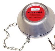
Lüftungsdeckel mit Festkupplung, mit Gewinde Rp4", aus Aluminium (System Storz Typ A-110) inklusive Steckschloss und Kette Art.-Nr. 18355.000X Gewicht: 1,1 kg
