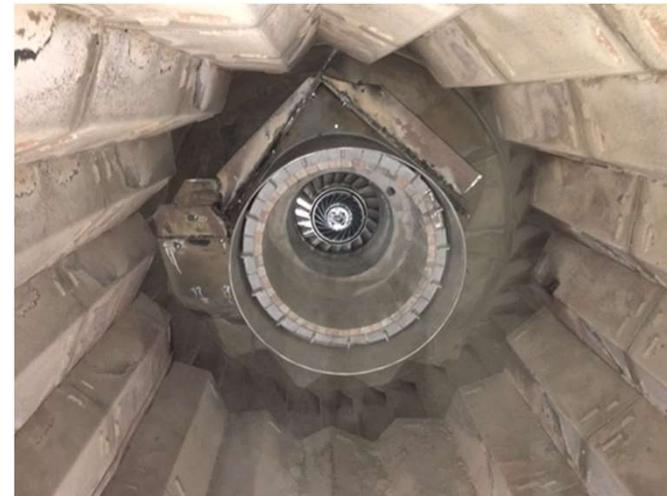
Innenansicht der Trockentrommel mit Brenner
