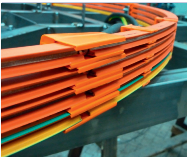
Schleifringkörper mit Einzelschleifleitung, wird projektbezogen nach Durchmesser gefertigt
