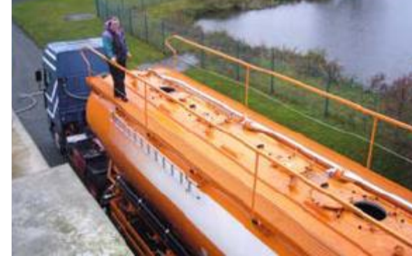
Hydraulische Befüllung aus Silotransporter
