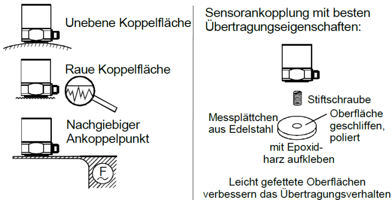
Bild 4: Empfehlungen zur Sensorankopplung
