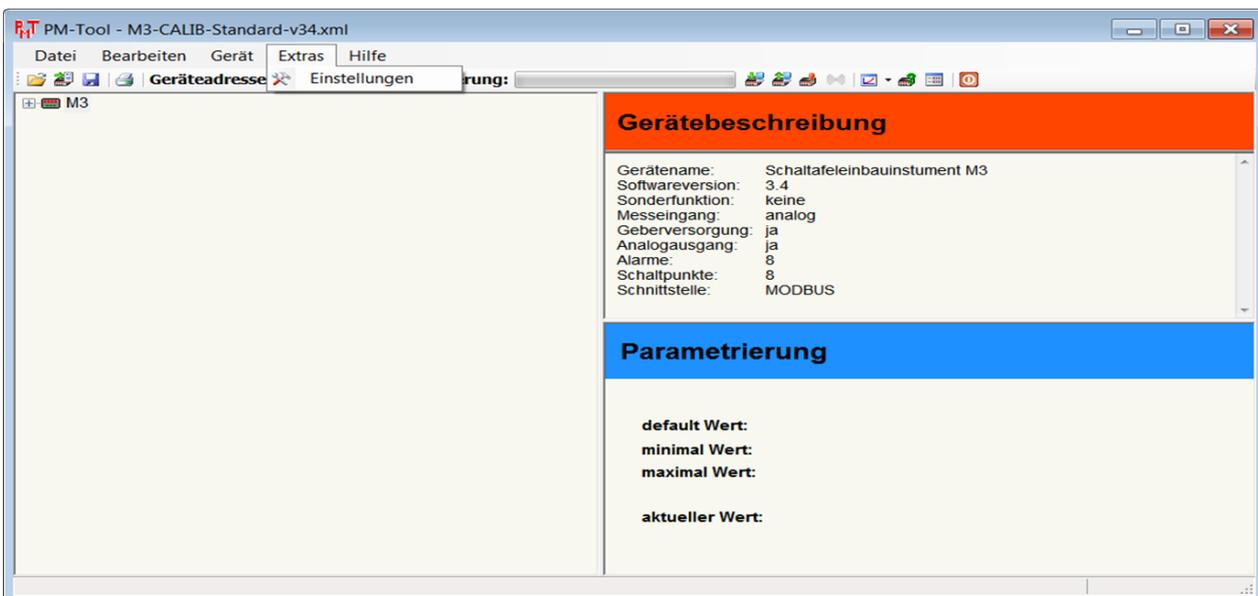
Über eine Auswahlbox lässt sich eine der verfügbaren COM-Adressen auswählen. Ein Standard-PC verfügt in der Regel über zwei COM-Schnittstellen. Sollte ein Laptop eingesetzt werden, wird in der Regel ein USB-RS232 Gateway eingesetzt. Der Treiber des Gateways simuliert eine RS232-Schnittstelle, sodass sich ein COM-Port frei zuordnen lässt und ebenfalls mit dieser Software läuft.
