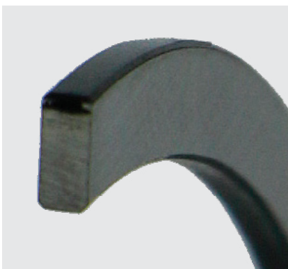
Abb. 1: DLC-Beschichtung auf der Lauffläche
