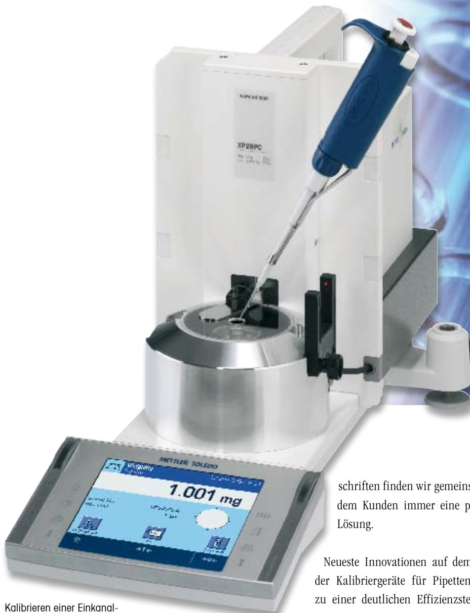
Kalibrieren einer Einkanal-Mikropipette mit der Mikrowaage XP26PC
