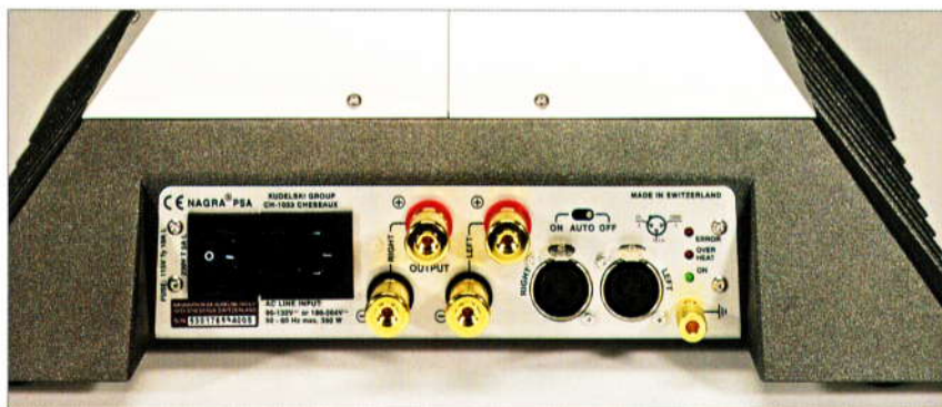
Dockingstation: Cinchstecker finden per Adapter Anschluss an die XLR-Eingänge; die optionale Einschaltautomatik funktioniert am besten mit Nagra-Equipment
