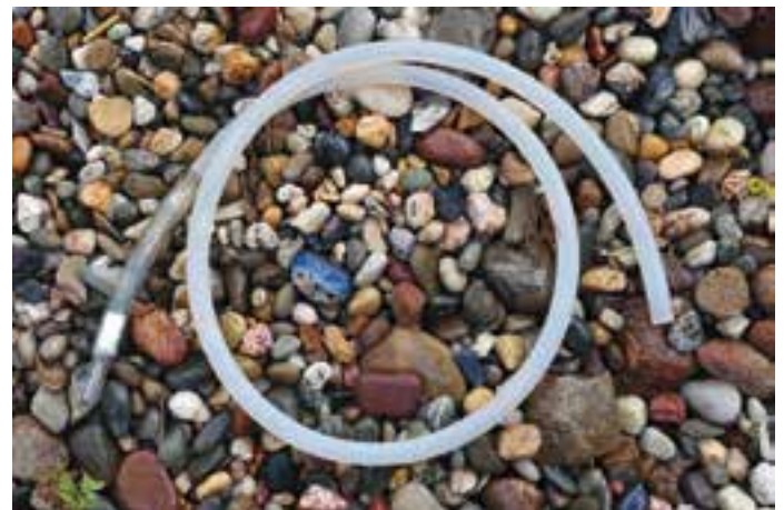
Abb. 7-1: Exhaustor. Spezielle Ausführung für die Arbeit mit kleinen Webspinnen.
