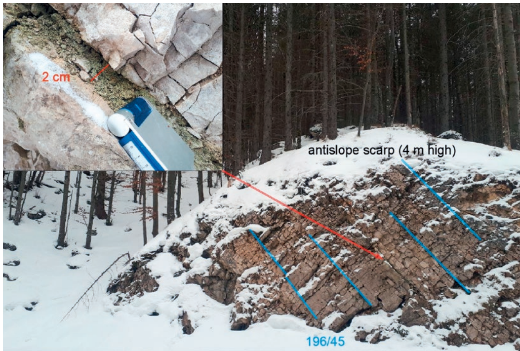
ABB. 15: Verwitterte Mergelzwischenlage im SSW-fallenden Plattenkalk, die in einem Anschnitt der Forststraße am SSW-Hang (Nackental, 915 m SH) freigelegt wurde.
