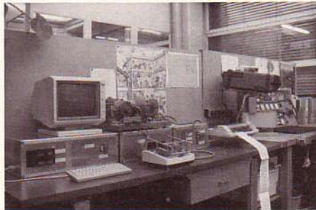
Bild 1. Hier sieht man das ganze Testgerät mit dem Drucker für die Typenschilder, auf dem mittleren Gehäuse befindet sich der Prüf- und Bremsmotor.
