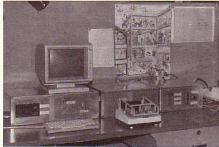
Bild 2. Bei diesem Bild sieht man das Testgerät mit dem Nadeladapter, im linken Gehäuse ist der Computer und die beiden Drives, in der Mitte sind die Schaltungen für die Schnittstellen und Stimulimodule. Im rechten Gehäuse sind die Netzteile.
