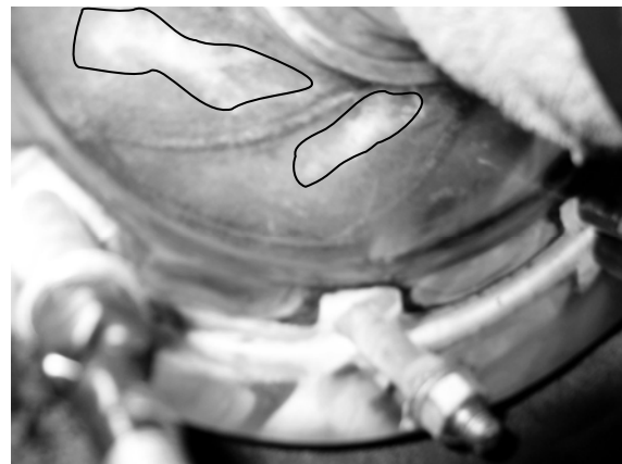
Bild 6b. Die Blasenschwärme der vollentwickelten Kavitation sind in zwei Schaufelkanälen ebenfalls mit geschlossenen Kurven markiert.
