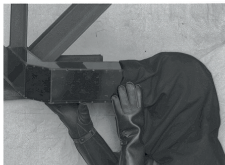
Bild 11: Bewertung der Schweißnaht mit einem Leuchtschirm
