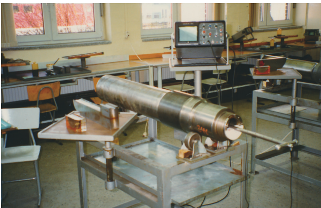
Bild 40: US-Praxisraum 2 zum Prüfen von Achsen, Rädern und Schienen
