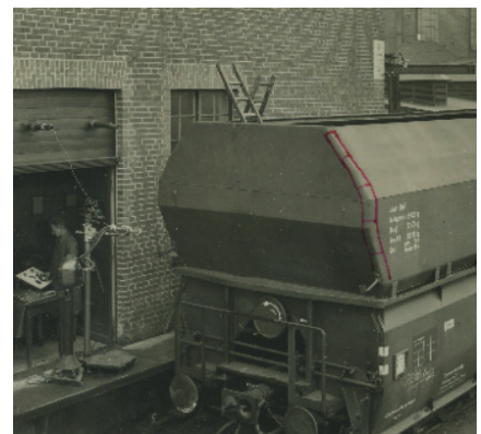
Bild 12: Ergebnis der Prüfung – Die rot gekennzeichneten Schweißnahtbereiche sind fehlerhaft
