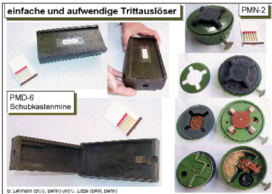
Abb. 6: Antipersonenminen: Sprengminen unterschiedlicher Bauart, die durch Auftreten ausgelöst werden. Im einfachen Fall sind es Holz- oder Plastikkästen, in die Sprengladung und Auslöser eingesetzt werden. Durch eine Feder sind die Kästen nicht vollständig geschlossen. Durch Auftreten wird die Feder zusammengedrückt und der Zünder ausgelöst (linker Teil der Abbildung). Aufwendiger gebaute Minen reagieren nicht auf leichtes Auftreten eines Tieres noch auf einen kurzen Tritt einer rennenden Person. Erst der anhaltende Druck einer stehenden Person löst die Mine aus (rechter Teil)
