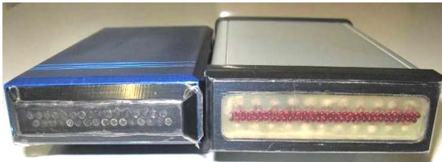
Bild 3: Links: Sensorzeile 32, 1,5-mm-Ferritkerne, Halbtransmission, Spulenabstand 3 mm, Gesamtpurbreite 45 mm, Sensorabstand ca. 1,5 mm. Rechts: Sensorzeile 64, 1,05-mm-Ferritkerne, Halbtransmission, Spulenabstand 2 mm, Gesamtpurbreite 61 mm, Sensorabstand ca. 1 mm
