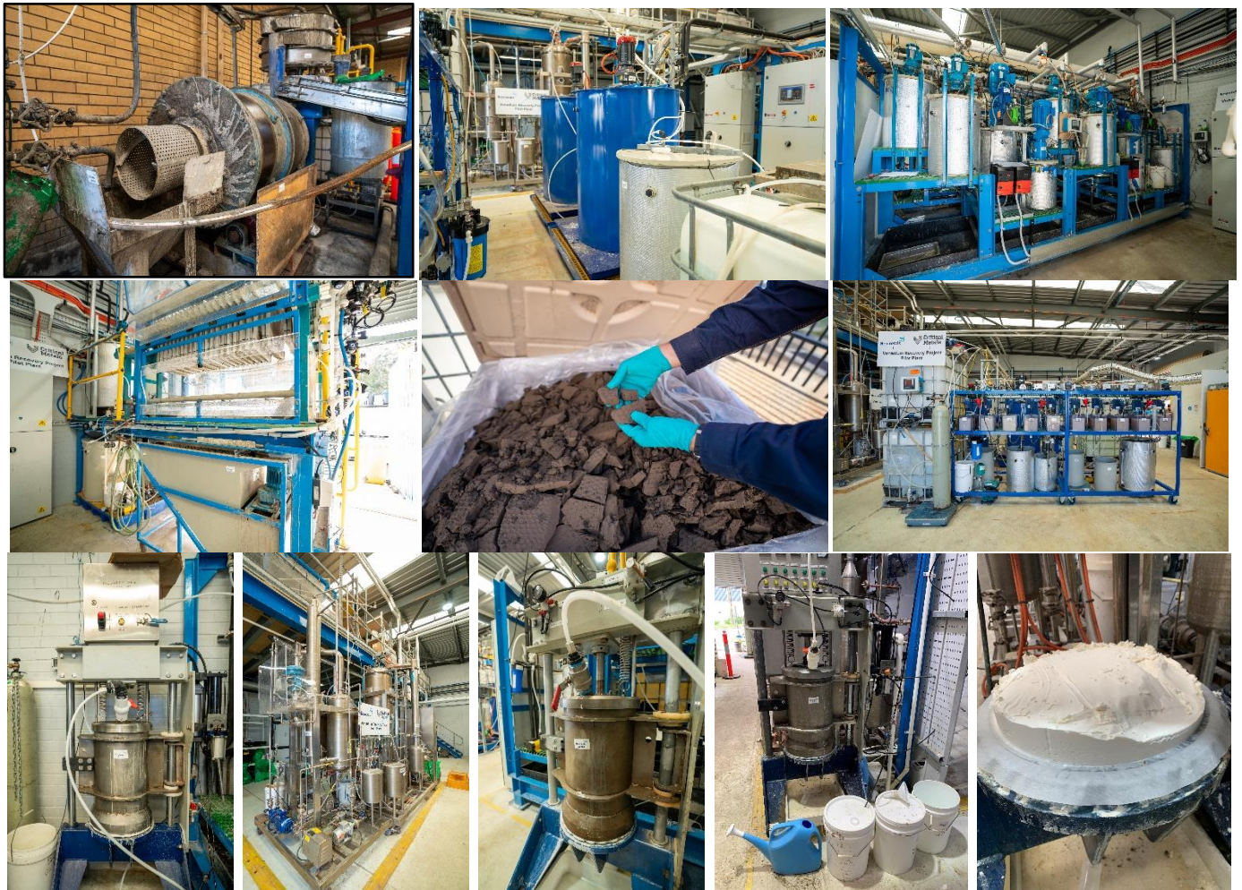
Abb. 1–11: Ausgewählte Bilder der Pilotanlage Reihe 1 (Abb. 1–3, von links nach rechts): die Kugelmühle, die Laugungszufuhr tanks sowie der integrierte Laugungs- und Mahlkreislauf Reihe 2 (Abb. 4–6, von links nach rechts): der Laugungsrückstandsfilter, der Laugungsrückstandsfilterkuchen und der Lösungsmittel-extraktionskreislauf Reihe 3 (Abb. 7–11, von links nach rechts): der Laugungszufuhr-Aufbereitungsfilter, der Prozesswasserverdampfer, der Desilifizierungsfilter, der AMV-Filter und ein Beispielsatz des AMV-Filterkuchens
