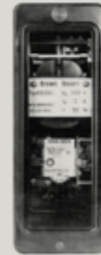
Abb. 10 Erdschluss- richtungsrelais CG26i, BBC, 1960
