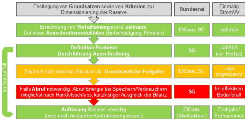
Abbildung 2: Die wichtigsten Prozessschritte, die Hauptverantwortlichen (SG = Swissgrid) sowie die Zeitpunkte der Schritte für die Energiereserve. Hauptverantwortliche sind in fetter Schrift dargestellt, weitere direkt Involvierte in normaler Schrift. Zur Farbgebung: grau = einmaliger und vorbereitender Schritt; grün = Schritte finden im Normalfall jährlich statt; gelb = Schritt findet nur statt, wenn sich eine kritische Versorgungssituation abzeichnet, diese aber noch nicht eingetreten ist; rot = Schritt zum Abruf der Reserveenergie, falls sich eine effektive Knappheitsituation ergibt.
