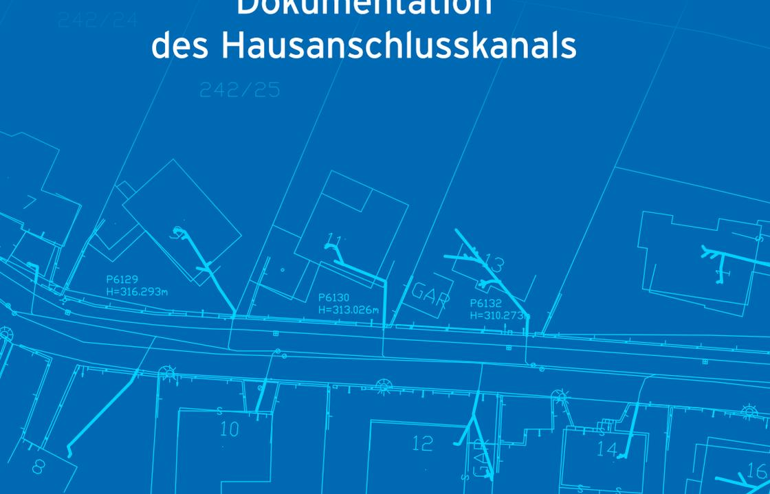
Die Dokumentation eines bestehenden Hausanschlusskanales sollte das gesamte Kanalleitungssystem von den Einmündungen der Fallrohre bis zur Grundstücksgrenze erfassen. Die Darstellung sollte mittels Lageplan zumindest im Maßstab 1:100 erfolgen.
