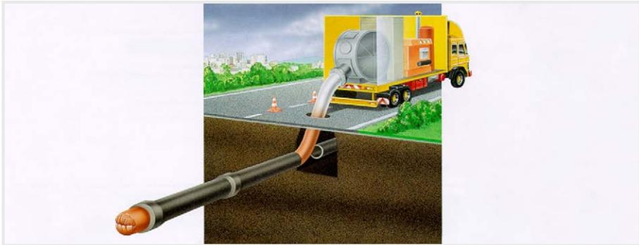
Abbildung 34 | Prinzipskizze Schlauchrelining
