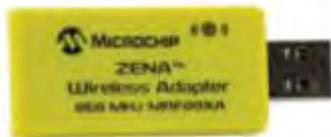
Wahlweise können Sie einen kabellosen Adapter (Teilenummer 39671 - 868 MHz oder Teilenummer 39672 - 915 MHz) in einen USB-Anschluss Ihres PCs einstecken.
