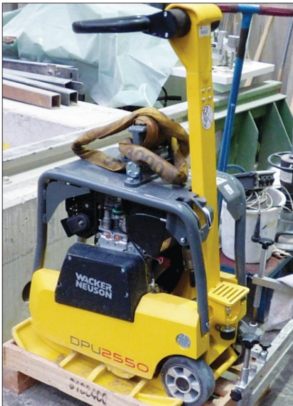
Bild 5-4: Vibrationsplatte Wacker DPU 2550
