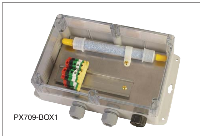
PX709-BOX1 Wasserdichter Anschlusskasten zur Verdrahtung des PXM709 und Aufnahme des Trocknungsmittels. Optional mit Blitzschutz für die angeschlossenen Geräte.
