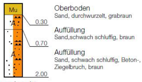
Abb. 2: Bodenprofile am Beispiel der Bohrpunkte 17 und 18 Quelle: UNDERyourfeet Ingenieurgesellschaft für Geotechnik mbH 06/2022
