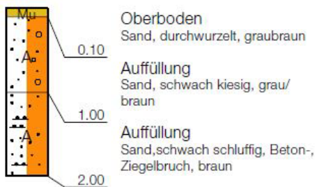
Abb. 2: Bodenprofile am Beispiel der Bohrpunkte 17 und 18 Quelle: UNDERyourfeet Ingenieurgesellschaft für Geotechnik mbH 06/2022
