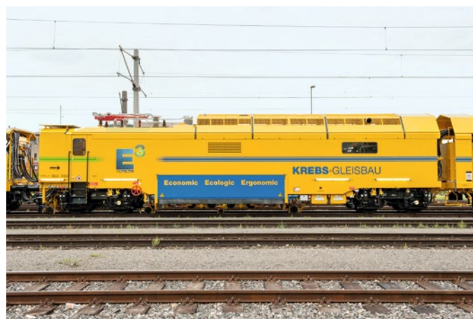
7: Der Hybridantriebswagen mit durch die Schallabschirmung verdecktem DGS Foto: Plasser & Theurer
