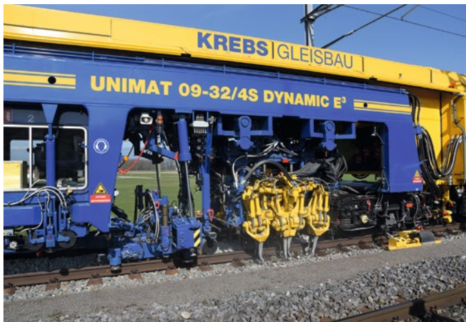
4: 2-Schwellen-Stopfaggregat für kontinuierliches Arbeiten Foto: Plasser & Theurer
