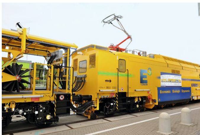
6: Stromabnehmer und dicke Elektrokabel kennzeichnen die E 3 -Maschine Foto: Achim Uhlenhut
