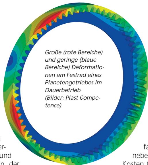
*Große (rote Bereiche) und geringe (blaue Bereiche) Deformationen am Festrad eines Planetengetriebes im Dauerbetrieb (Bilder: Plast Competence)*
