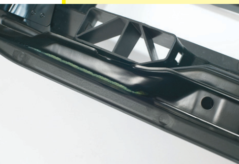
Durchgehende Klebnaht im Hybrid-Frontend des neuen Polo
