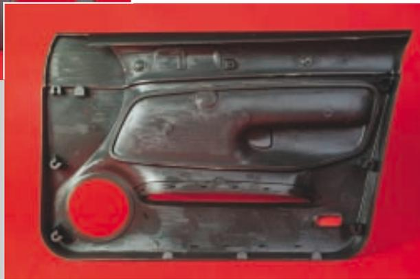
In Kraftfahrzeugen setzt sich eine Türinnenverkleidung oft aus verschiedenen Teilen und Materialien zusammen, die es in Folgearbeitsgängen zu komplettieren gilt. Eine Machbarkeitsstudie bewies, dass es möglich ist, auf einer herkömmlichen Spritzgießmaschine in einem Arbeitsgang eine komplette Türinnenverkleidung herzustellen.
