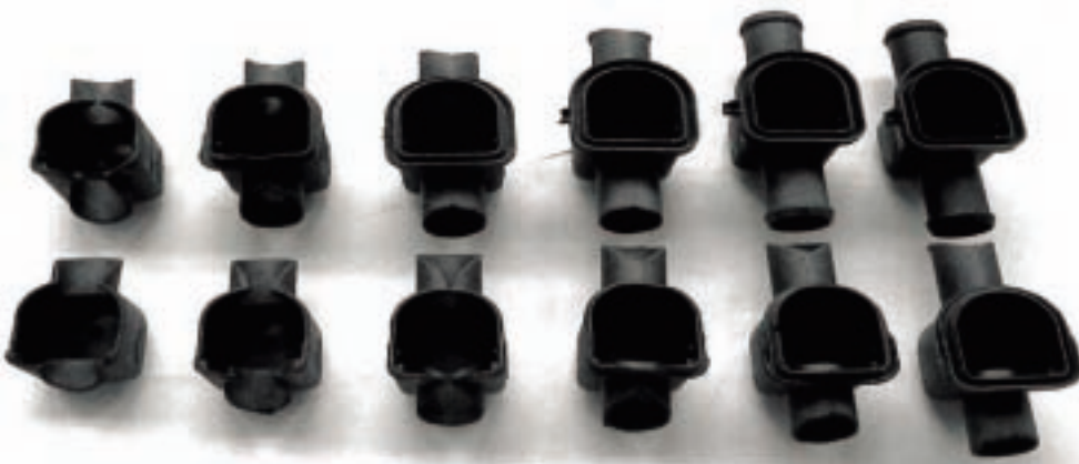
Eine Füllstudie zeigt Schritt um Schritt, wie die Formteile im Werkzeug entstehen. Ferner gibt sie entscheidende Hinweise auf Ungleichmäßigkeiten, Lufteinschlüsse und die Lage von Bindenähten.
