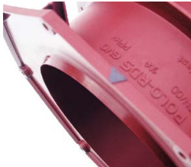
Am Mauerflansch sind Achsmarkierungen für die Positionierung des Lamellenrohres auf der Schalung vorhanden.
