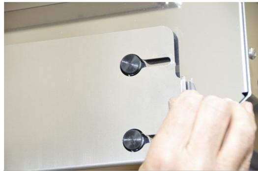
2. Schieben Sie die Klappe nach rechts, um die Zunge vom Sicherheitsschalter zu lösen.
