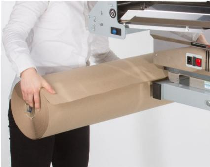
1. Schieben Sie unter Beachtung der Abwickelrichtung eine neue Papierrolle auf den Papierhalter, bis die gefederte Sicherungsklinke nach oben springt.
