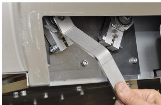
4. Setzen Sie das Schneideklingen-Rückstellwerkzeug (mitgeliefert) auf die Kurbelmutter. Drehen Sie die Kurbel im Uhrzeigersinn in die gezeigte Position.
