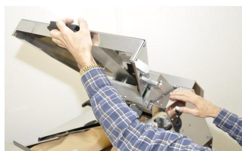
4. Heben Sie die obere Abdeckung an, drücken Sie den Druckbolzen zum Lösen hinein und senken Sie die obere Abdeckung ab.
