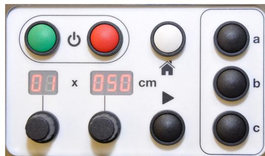
4. Lassen Sie die Preset-Taste los, um die Werte zu speichern – das Display blinkt zweimal, bevor es kontinuierlich leuchtet.
