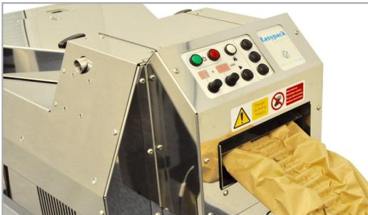
3. Die Maschine erzeugt die voreingestellte Menge und Länge der Kissen in der eingestellten Länge.
