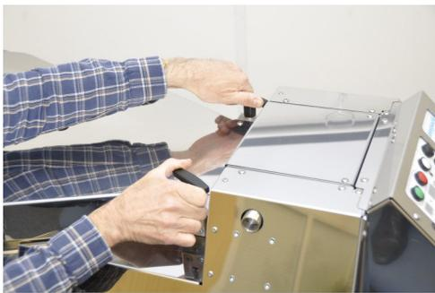
1. Lösen Sie die beiden schwarzen Knebelgriffe auf beiden Seiten der oberen Abdeckung, bis sie nach unten schwenken.
