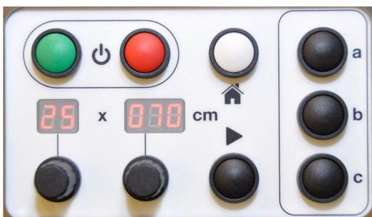
3. Entfernen Sie jegliches Material aus dem Auslaufkanal. **Stellen Sie sicher, dass genügend Platz für den Auslauf der Kissen aus dem Auslaufkanal vorhanden ist.** Drücken Sie die schwarze „Start“-Taste, um den Zyklus
