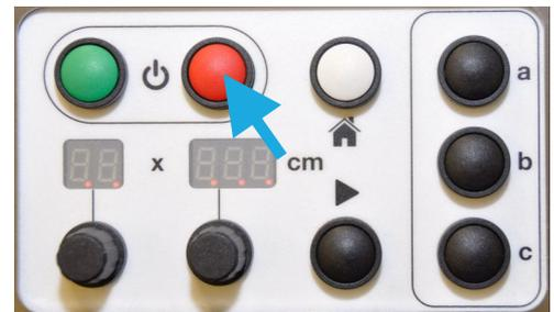
5. Die Maschine kann durch Drücken der roten „Aus“-Taste gestoppt werden.
