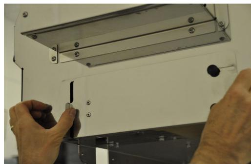
4. Setzen Sie die Klappe der Abtrennvorrichtung wieder ein und richten Sie dabei die Zunge des Sicherheitschalters wieder aus. Ziehen Sie die beiden schwarzen Knöpfe fest.
