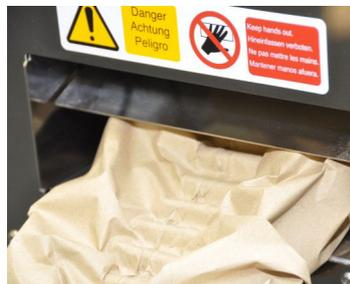
4. Die Maschine schaltet sich bei geöffneter Auslaufklappe nicht ein oder startet nicht.
