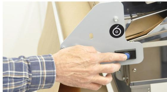
4. Drücken Sie die blaue Einzugstaste und lassen Sie sie los. Das Papier wird automatisch geladen.
