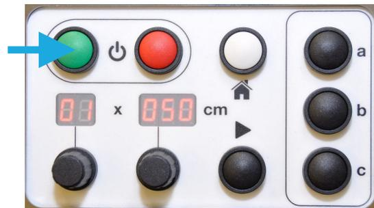
4. Schalten Sie das Gerät ein, indem Sie die grüne Taste „I“ drücken. Das Display leuchtet auf. Werden auf dem Display blinkende „Bindestriche“ angezeigt, muss die Maschine mit einer Papierrolle beladen werden.
