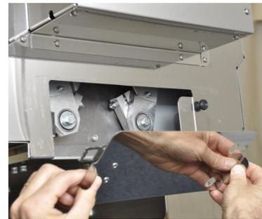
2. Die Maschine schaltet sich bei geöffneter Klappe der Abtrennvorrichtung nicht ein oder läuft nicht.
