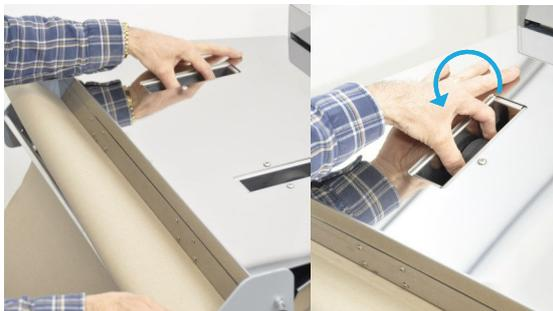
3. Drehen Sie die Räder mit der Hand um etwa eine halbe Umdrehung, damit das Papier eingeführt und erfasst wird.
