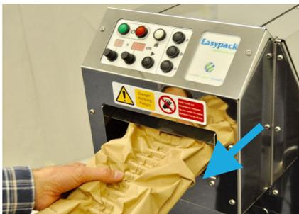
1. Entfernen Sie jegliches Material aus dem Auslaufkanal und stellen Sie sicher, dass die Auslaufklappe geschlossen ist.
