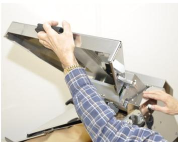
3. Die Maschine schaltet sich bei angehobener oberer Abdeckung nicht ein oder läuft nicht.
