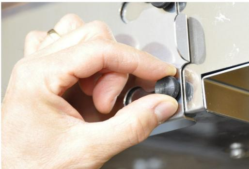
1. Lösen Sie die beiden schwarzen Knöpfe, die die Klappe der Abtrennvorrichtung unter dem Auslaufkanal sichern.
