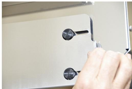
2. Entfernen Sie die Klappe der Abtrennvorrichtung, indem Sie sie nach rechts schieben und nach vorne anheben.
