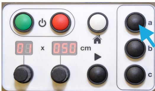
1. Halten Sie eine der Preset-Tasten (a, b oder c) gedrückt – die Anzeige beginnt nach 2 Sekunden zu blinken.
