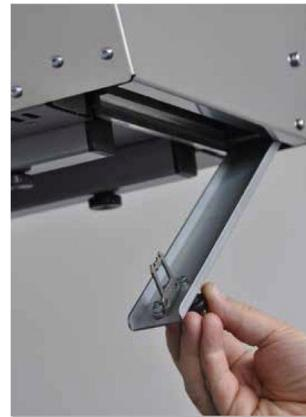
2. Die Maschine schaltet sich bei geöffneter Klappe der Abtrennvorrichtung nicht ein bzw. läuft nicht.
