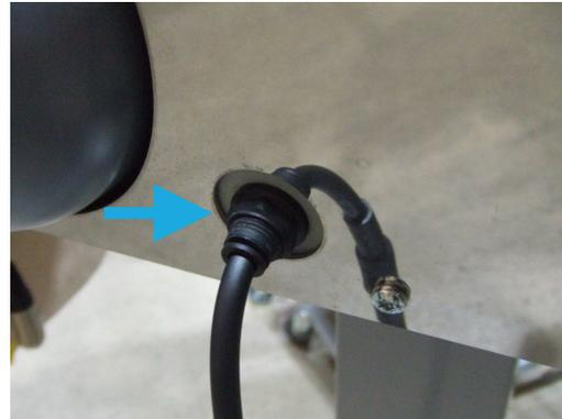
2. Das Fußschalterkabel ist an die Maschine angeschlossen.
