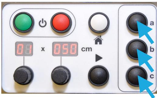
1. Drücken Sie eine der Preset-Tasten (a, b oder c) – die Anzeige wechselt auf den voreingestellten Wert.
