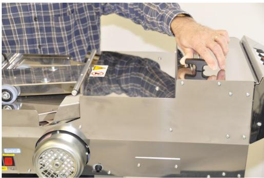
1. Lösen und entfernen Sie die beiden schwarzen T-Griffe auf beiden Seiten der oberen Abdeckung.
