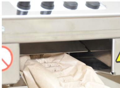
4. Die Maschine schaltet sich bei geöffneter Auslaufklappe nicht ein bzw. startet nicht.
