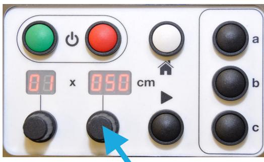
3. Drehen Sie den Drehknopf zur Einstellung der Länge auf die gewünschte Länge (während das Display blinkt).
