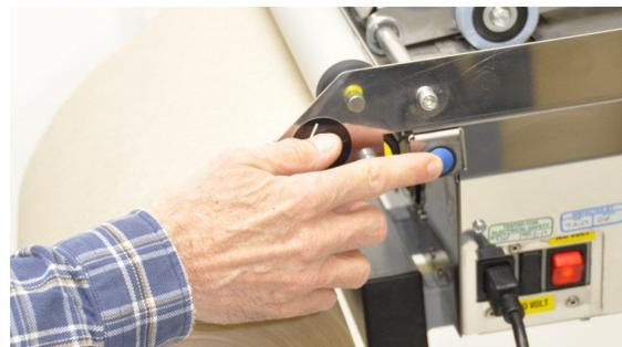
4. Drücken Sie die blaue Einzugstaste und lassen Sie sie los. Das Papier wird automatisch eingezogen.
