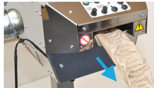
4. Die Maschine produziert im Endlosbetrieb die eingestellte Anzahl von Kissen.
