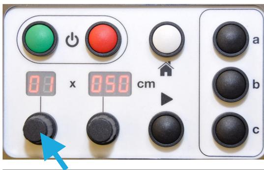
1. Drehen Sie den Drehknopf zur Einstellung der Menge auf „01“.
