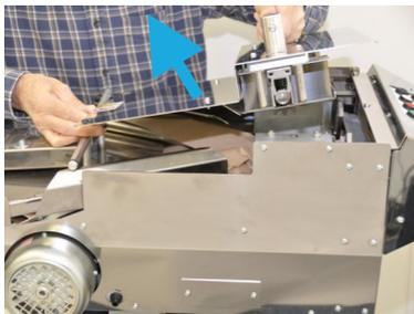
3. Die Maschine schaltet sich bei angehobener, oberer Abdeckung nicht ein bzw. läuft nicht.
