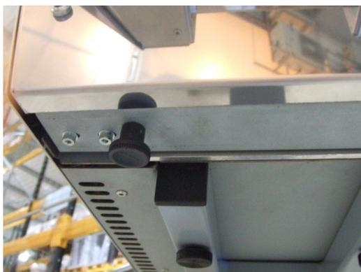
1. Machen Sie die Klappe der Abtrennvorrichtung auf der Unterseite der Maschine unter dem Auslaufkanal ausfindig.
