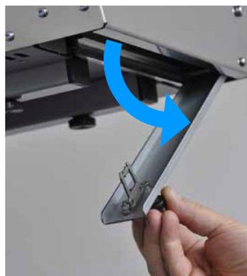
2. Stellen Sie einen Behälter unter die Klappe der Abtrennvorrichtung und ziehen Sie stark am schwarzen Knopf, um die Klappe zu öffnen.
