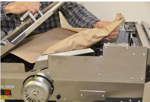
3. Schneiden Sie das Papier entlang der Papierrolle an den Einzugsführungsstangen mit einem Messer ab.
