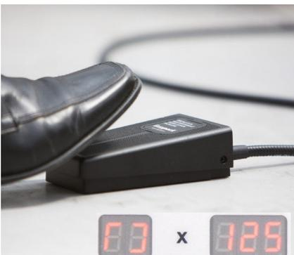
2. Halten Sie den Fußschalter betätigt. Die Längenanzeige erhöht sich mit der Herstellung der Kissen und die Mengenanzeige schaltet auf ein umlaufendes Symbol um.
