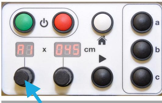
1. Drehen Sie den Drehknopf zur Einstellung der Menge gegen den Uhrzeigersinn auf „A1“.
