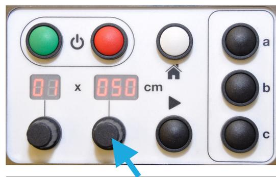
2. Drehen Sie den Drehknopf zur Einstellung der Länge auf die gewünschte Länge.
