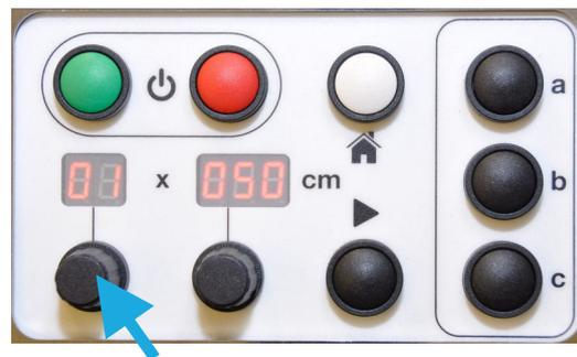
2. Drehen Sie, während Sie gleichzeitig die Preset-Taste gedrückt halten, den Drehknopf zur Einstellung der Menge auf die gewünschte Anzahl von 01 bis 99 (während das Display blinkt).
