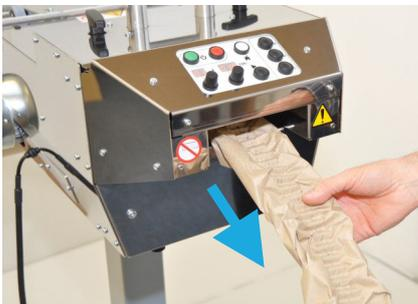
1. Entfernen Sie jegliches Material aus dem Auslaufkanal und stellen Sie sicher, dass die Auslaufklappe geschlossen ist.
