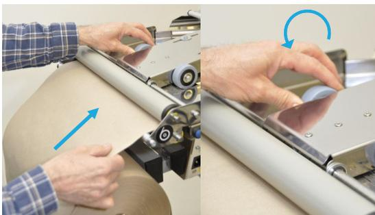
3. Drehen Sie die Räder mit der Hand **um etwa eine halbe Umdrehung**, damit das Papier eingezogen und erfasst wird.
