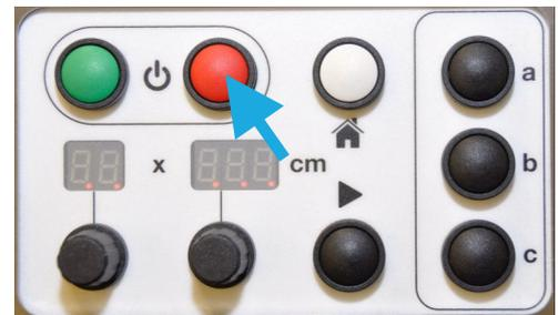
5. Die Maschine kann durch Drücken der roten „Off-(Aus)“-Taste angehalten werden.
