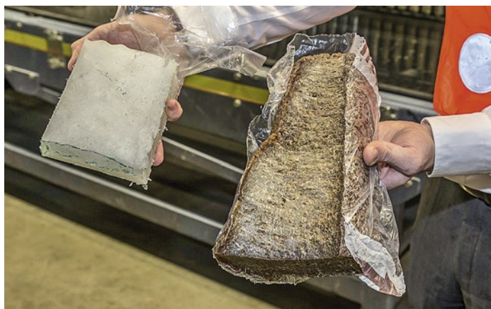
Kautschuk ist Hauptbestandteil eines Gummireifens. Rechts in natürlicher Form, links synthetisch hergestellt.
