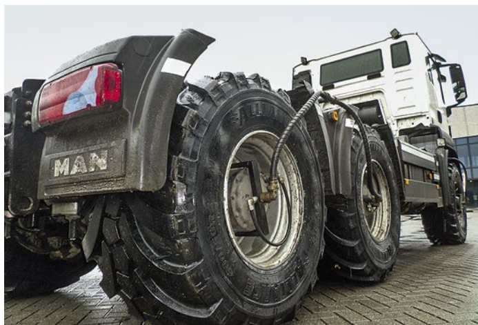
Da auf dem Acker mit nur 0,8 bar gefahren werden kann, auf der Straße aber bis zu 6,5 bar ideal sind, empfiehlt sich eine Reifendruckregelanlage.
