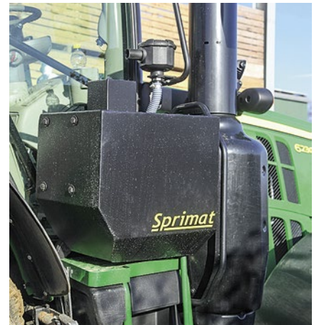
Wechselt man häufig zwischen Feld und Straße (Ladewagen etc.), muss ein Zusatzkompressor her. Sonst reicht der Schlepperkompressor.
