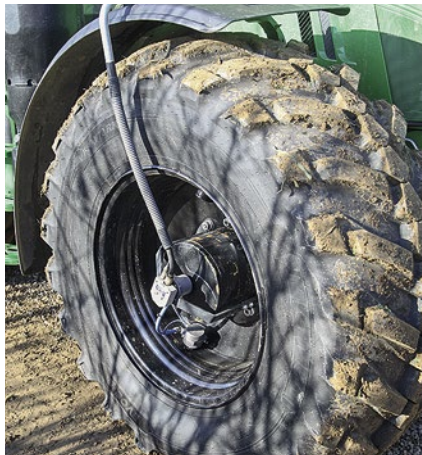
Die Reifendruckregeltechnik hat Michelin von PTG übernommen. Sie arbeitet mit zwei Leitungen und Drehüberträgern von außen.
