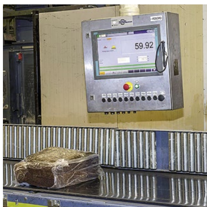
Wie bei einem klassischen Rezept werden die einzelnen Mischungszutaten verwogen und in den Mixer gegeben.
