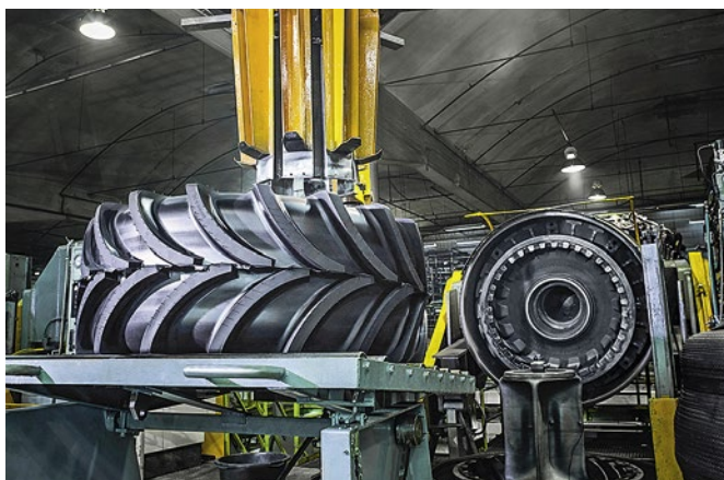
Von plastisch nach elastisch! Der grune Reifen wird nun endgultig in Form gebracht. Bei mehr als 160° C und uber 10 bar Druck verschmelzen die einzelnen Gummikomponenten miteinander. Das Resultat dieser Vulkanisation: ein hoch belastbarer Reifen.
