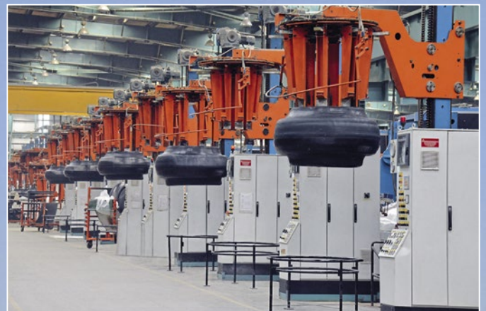
Die indische Produktion hat westlichen Standard. Insgesamt gibt es 177 Autoklaven zum Vulkanisieren der bis zu 51 Zoll großen Reifen.
