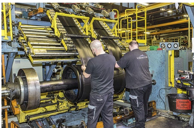
Die einzelnen Reifenlagen werden Schicht fur Schicht von den Mitarbeitern mit Hilfe der sich drehenden Trommel aufgezogen. Nach dem die einzelnen Lagen auf der Trommel aufgelegt wurden, werden jetzt die Seitenwande aufgeklebt. Lasermarkierungen geben den Mitarbeitern die Position vor.
