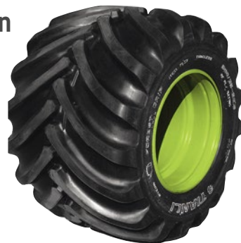
Der neue Forest Grip ist der erste Reifen der Größe 800/35 R 22.5. Produziert wird er von Tutric aus dem chinesischen Tianjin.
