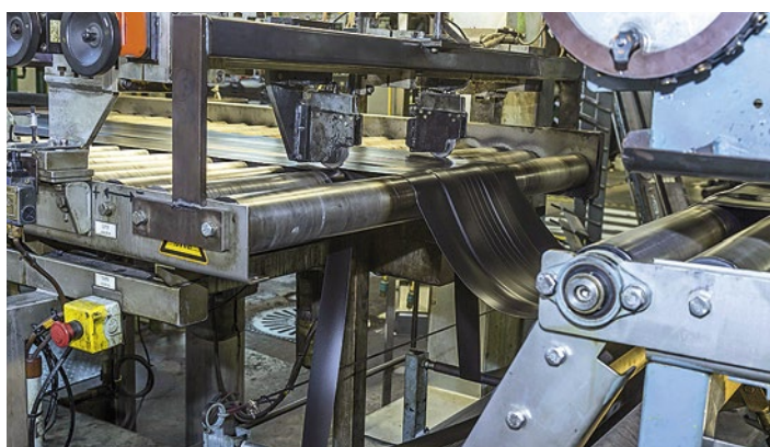
Nach der Formgebung wird das Reifenbauteil schnell abgekühlt und hier millimetergenau zugeschnitten, damit z.B. die Seitenwand exakt geformt ist.
