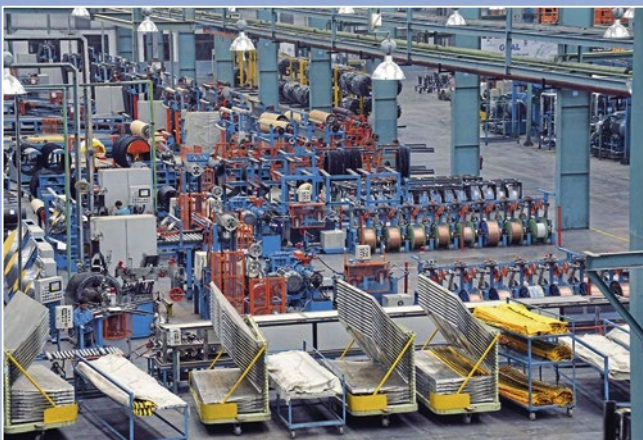
Die indische Produktion hat westlichen Standard. Insgesamt gibt es 177 Autoklaven zum Vulkanisieren der bis zu 51 Zoll großen Reifen.
