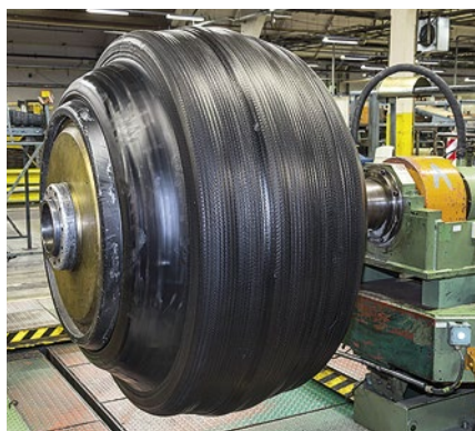
Mit Luftdruck und Druck der felgenahnlichen Flansche entsteht der „grune“ Reifen.
