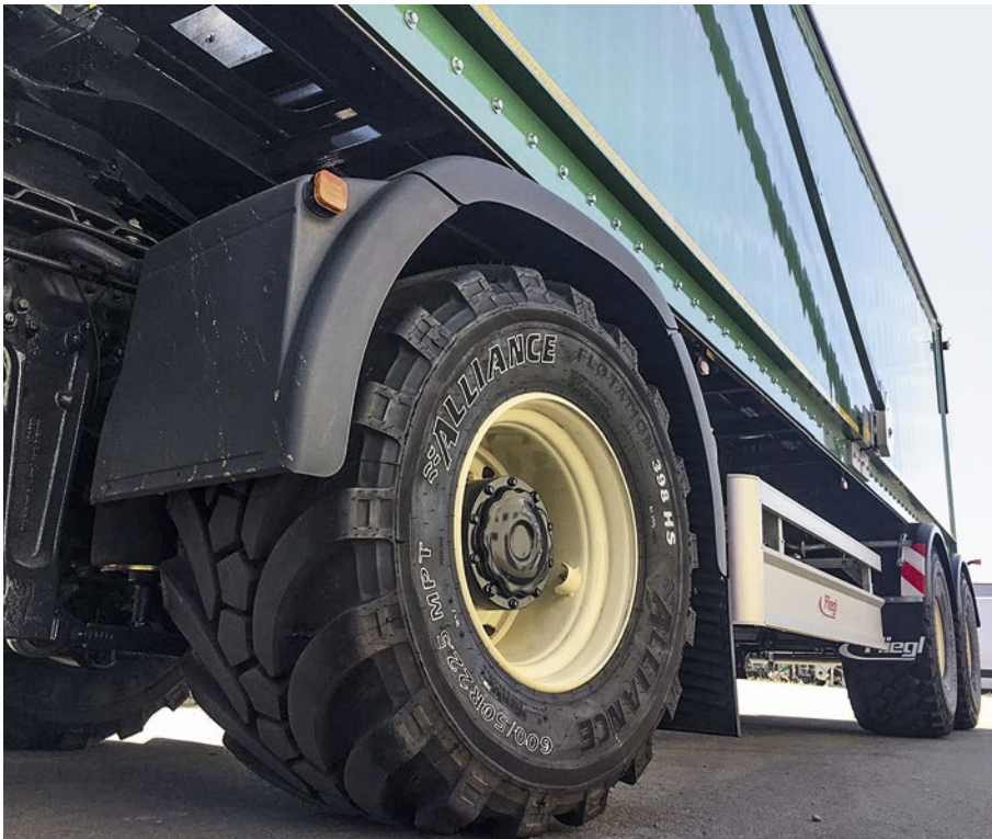
„S“-Mittelblöcke sorgen für Fahrkomfort auf der Straße. Querstollen und weit öffnende Reifenschultern sollen Traktion und Selbstreinigung auf dem Acker sicherstellen.
