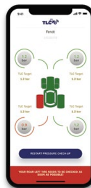
Von den Ventilkappen wird der Reifendruck über ein Gateway zur App in jedes (mobiles) Endgerät übertragen.
