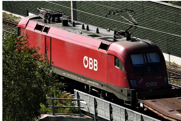
Abbildung 1: Lokomotive mit etwa 90 Tonnen Gewicht
