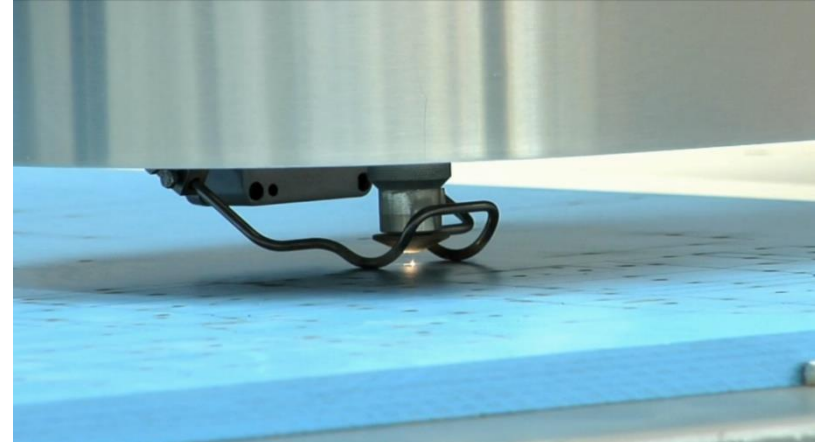
Lasern der Trägerplatte
