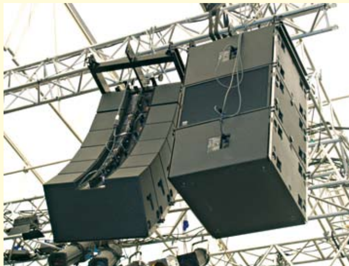
Linearray mit SEQUENZA 10, daneben rechts die Subwoofer SEQUENZA 10B, von denen der mittlere um 180° gedreht ist
