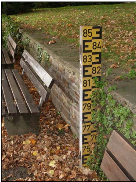
Abbildung 9 Pegelmesslatte zur Bestimmung des Wasserstandes
