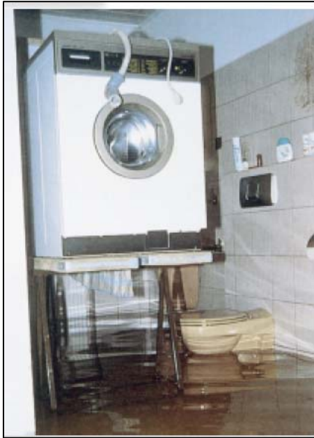
Abbildung 14 Hochlagerung von Geräten
