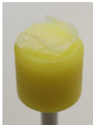
Abbildung 46: Poröses PDO-Scaffold für \mu CT-Analyse auf Probenhalter. Zur Analyse mittels \mu CT wurde ein Scaffold mit einem Durchmesser von 17 mm auf dem Probenhalter platziert.
